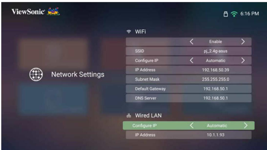
3. Sie können die IP automatisch oder manuell konfigurieren. Durch Auswahl von **Manual (Manuell)** können Sie auf **IP Address (IP-Adresse)**, **Subnet Mask (Subnetzmaske)**, **Default Gateway (Standard-Gateway)** und **DNS Server (DNS-Server)** zugreifen.
