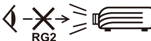
**ACHTUNG:** Dieses Gerät gibt mögliche gefährliche optische Strahlung ab. Blicken Sie wie bei jeder hellen Lichtquelle nicht direkt in den Strahl, RG2 IEC 62471-5:2015
