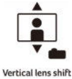
Die Lens Shift-Funktion (Linsenverschiebung) erleichtert Ihnen speziell die Installation des Projektors. Mittels zweier Rädchen an der Seite des Projektors können Sie das Bild verzerrungsfrei nach oben oder unten verschieben.
