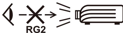
**ACHTUNG:** Möglicherweise gefährliche optische Strahlung könnte von diesem Produkt emittiert werden. Wie bei jeder hellen Lichtquelle nicht in den Strahl blicken, RG2 IEC 62471-5:2015.
