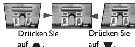
2. Die Seite für die **Schrägposition** Korrektur wird angezeigt. Drücken Sie auf ▲ , um die Schrägposition oben im Bild zu korrigieren. Drücken Sie auf ▼ , um die Schrägposition unten im Bild zu korrigieren.
