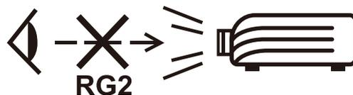
**ACHTUNG:** Dieses Gerät gibt mögliche gefährliche optische Strahlung ab. Blicken Sie wie bei allen hellen Lichtquellen nicht in den Strahl, RG2 IEC 62471-5:2015. Zusätzliche Warnung vor einer Exposition der Augen bei einer Exposition aus nächster Nähe von weniger als 1 m.
