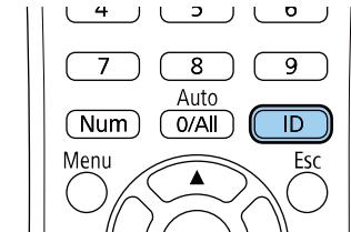
Die aktuelle Projektor-ID wird auf der Projektionsfläche angezeigt. Sie verschwindet nach etwa 3 Sekunden.
