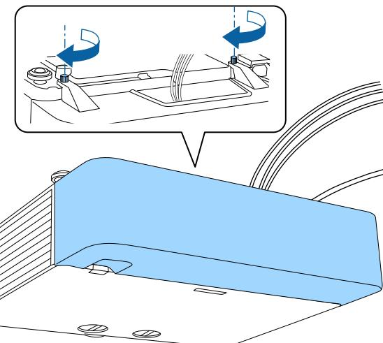
Entfernen Sie die Abdeckung, indem Sie die Abdeckungsschrauben lösen und die Abdeckung vom Projektor abziehen.
