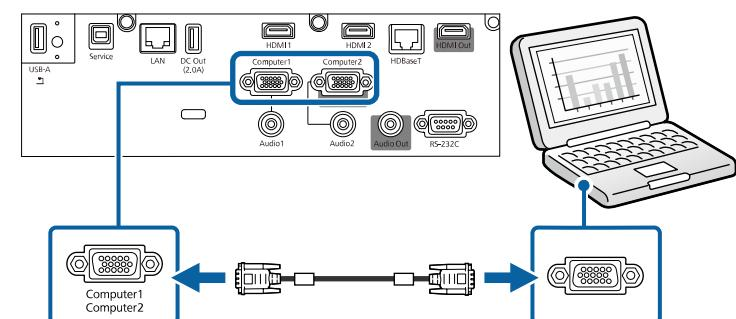
**3** Ziehen Sie die Schrauben am VGA-Anschluss fest.
