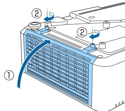
**3** Lösen Sie die Schrauben und öffnen Sie die Luftfilterabdeckung.
