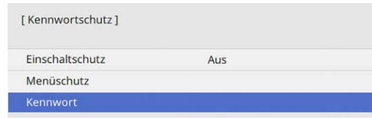
Falls dieses Menü nicht angezeigt wird, halten Sie die [Freeze]-Taste an der Fernbedienung 5 Sekunden lang gedrückt, bis das Menü erscheint.
