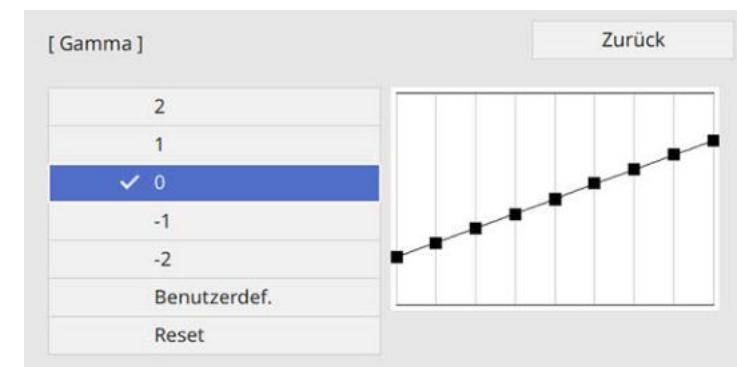
Durch Auswahl eines kleineren Wertes können Sie die Gesamthelligkeit des Bildes reduzieren, damit es schärfer dargestellt wird. Durch Auswahl eines größeren Wertes werden dunklere Bildbereiche heller, während jedoch die Farbsättigung in helleren Bereichen abnimmt.
