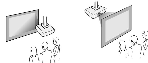
Wählen Sie die entsprechend der verwendeten Installationsmethode richtige **Projektion**-Option im Projektormenü **Installation**. Bei Bedarf schalten Sie Taste **Richtgsumkehr** im Projektormenü **Betrieb** ein und passen Menüdrehung im Projektormenü **Display** an.
