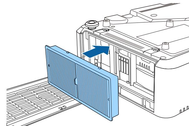
**9** Schließen Sie die Luftfilterabdeckung und ziehen Sie die Schrauben fest.
