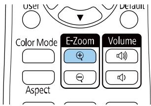
Das projizierte Bild wird vergrößert, wobei die Mitte des Bildes zentriert bleibt. Sie können das Bild in 25 Schritten ein- bis vierfach vergrößern.
