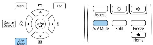
Die Lichtquelle schaltet sich aus und das projizierte Bild und der Ton werden unterbrochen.
