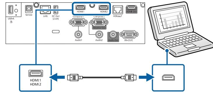
Falls Sie Probleme mit der Audioausgabe per HDMI-Verbindung haben, verbinden Sie ein Ende eines handelsüblichen Audiokabels (3,5 mm, Miniklinke, Stereo) mit dem Audio-Anschluss des Projektors und das andere Ende mit dem Audioausgang Ihres Computers. Wählen Sie den Audioeingang, zu dem Sie eine Verbindung hergestellt haben, als **HDMI-Audioausgang**-Einstellung im Projektormenü **Signal-I/O**.
