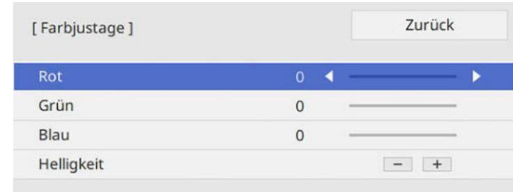
Mit den Tasten **Helligkeit** passen Sie die RGB-Werte gleichzeitig an.
