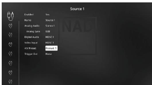
Im obigen Beispiel werden die Einstellungen „Preset 1“ (Voreinstellung 1) Quelle 1 zugeordnet. Jedes Mal, wenn auf Quelle 1 zugegriffen wird, werden die Einstellungen „Preset 1“ (Voreinstellung 1) auf Quelle 1 angewandt. Sie können die zugeordnete Voreinstellung einer spezifischen Quelle mit einer anderen Voreinstellung/ Voreinstellungsnummer manuell überschreiben, indem Sie die entsprechenden Tasten auf der Fernbedienung drücken.
