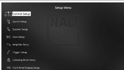
Im „Setup Menu“ kann der Betrieb des T 758 auf die Geräte in einem eigenen AV-System angepasst werden. Wenn Ihr System nicht genau den in der mitgelieferten Kurzanleitung aufgeführten Werkseinstellungen entspricht, müssen Sie die Eingänge im „Setup Menu“ des T 758 konfigurieren.
