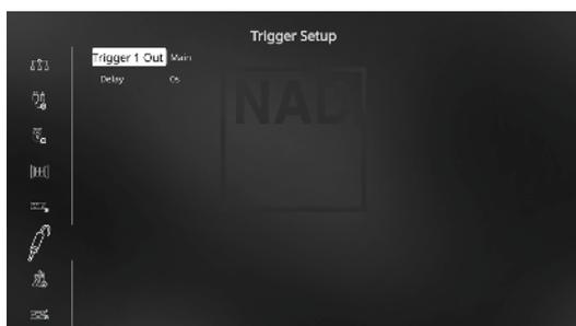
Das T 758 verfügt über einen konfigurierbaren +12V DC Trigger-Ausgang, der zur Aktivierung einer Komponente oder eines Systems verwendet werden kann, in die/das es gespeist wird. Es ist auch ein Triggereingang vorhanden, mit dem die zugeordnete Verbindung aktiviert werden kann.
