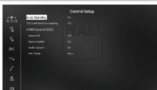
Der T 758 unterstützt HDMI-Steuerungs- und Audio Return Channel (ARC)-Funktionen. Beide Funktionen sind möglich, wenn externe Geräte, die ebenfalls beide Features unterstützen, über den HDMI-Anschluss mit dem T 758 verbunden sind.
