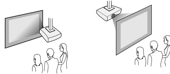
Wählen Sie die entsprechend der verwendeten Installationsmethode richtige **Projektion**-Option im Projektormenü **Installation**. Schalten Sie bei Bedarf die Einstellung **Taste Richtgsumkehr** im Projektormenü **Betrieb** ein.
