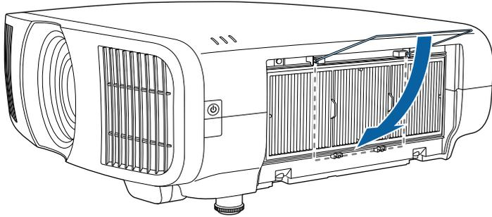
**7** Schließen Sie die Luftfilterabdeckung und ziehen Sie die Schrauben fest.
