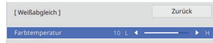
Höhere Werte färben das Bild bläulich, geringere Werte färben das Bild rötlich.
